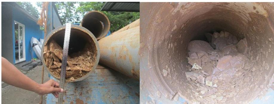
**Gambar III-19** Sedimentasi kapur pada pipa PDAM Rembang
